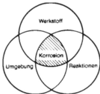
Korrosion ist die Reaktion eines metallischen Werkstoffs mit seiner Umgebung, die eine messbare Veränderung des Werkstoffs bewirkt und zu einer Beeinträchtigung der Funktion eines metallischen Bauteiles oder eines ganzen Systems führen kann. In den meisten Fällen ist diese Reaktion elektrochemischer Natur, in einigen Fällen kann sie jedoch auch chemischer oder metallphysikalischer Natur sein. (Definition Grundbegriff „Korrosion“ nach ISO 8044 / DIN 50900-1)
