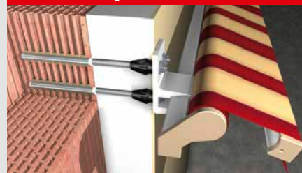
Detail: Sicherung von Wetterschalen
