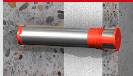
Detail: Sicherung von Wetterschalen
