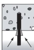
頭上位置に施工する場合は、インジェクションモルタルの硬化時間中、固定部材を楔クランプで固定してください。
