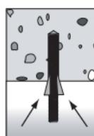
Si el montaje se realiza a una altura superior a la de la cabeza, el elemento de anclaje se debe fijar con cuñas de apriete durante el tiempo de endurecimiento.
