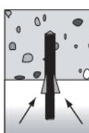
En cas d'installation au-dessus de la tête, fixez l'élément d'ancrage pendant le temps de durcissement du mortier à l'aide d'une cale.
