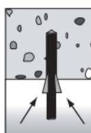
Fixeer bij montage boven lichaamslengte het verankeringselement tijdens de droogtijd van de mortel met wiggen.
