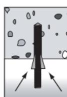
Ved montering over hovedhøjde skal forankringselementet fikseres med kiler, mens mørtlen hælder.
