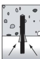
高处安装时，在砂浆硬固过程中通过楔形压板对锚固件进行固定。
