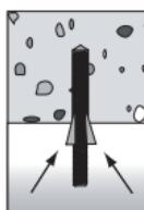
Bei Überkopfmontage das Verankerungselement während der Aushärtezeit des Mörtels durch Klemmkeile fixieren.
