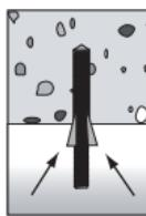
Per il montaggio sulla testata dell'elemento di ancoraggio, fissare mediante la chiavetta durante il tempo d'indurimento della calce.
