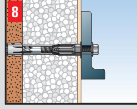
**7** (D) Anbauteil montieren, Schraube handfest anziehen.
