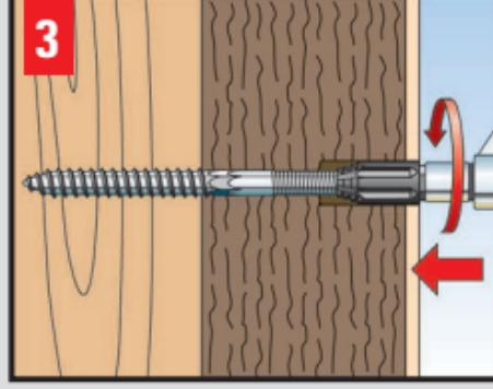
**3** (D) Einheit (ohne UX) ins Bohrloch stecken, Thermax einschrauben und justieren.
