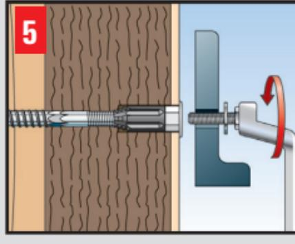
**5** (D) Anbauteil montieren, Schraube handfest anziehen.
